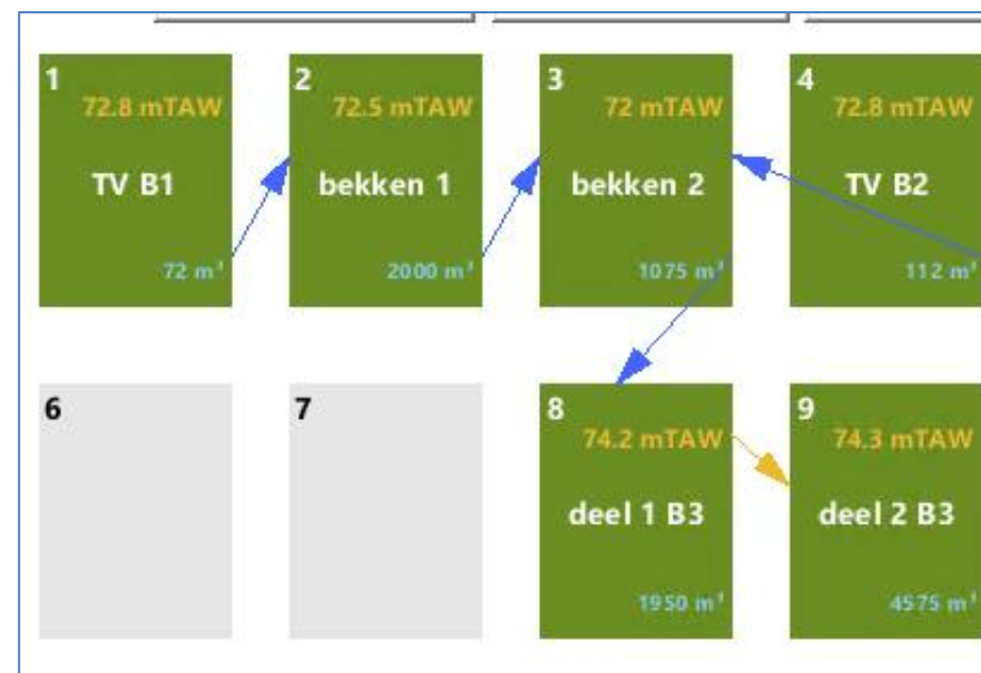
Figuur 13: schematische voorstelling van het wateropvang- en -buffersysteem op Heyeveld in de toekomstige situatie (TV = volume in toevoerleidingen)
