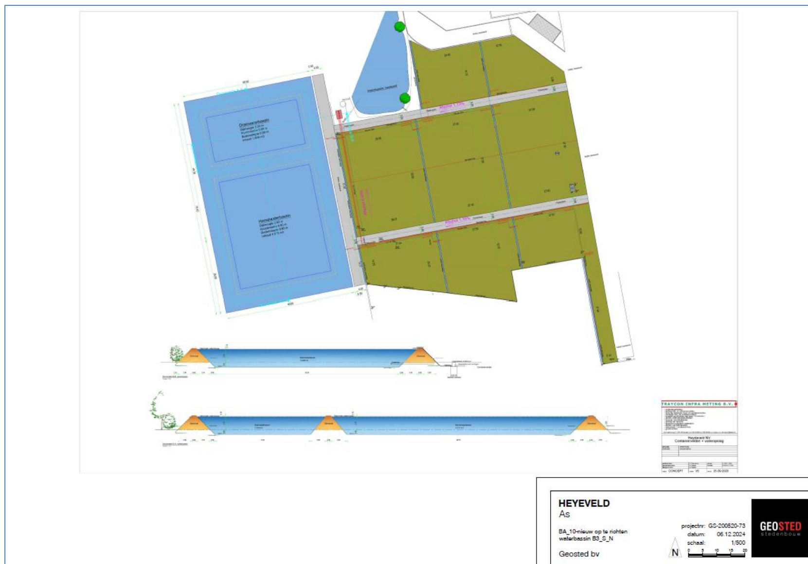
Figuur 10: grondplan en snedes van het nieuw te bouwen waterbassin
